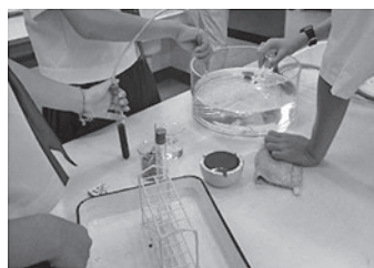
図7. 生徒による気体の捕集実験
